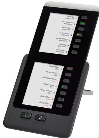
**Figura 16: Módulo de expansión clave para Cisco IP Phone 8865**
