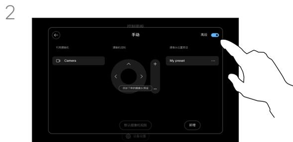
在控制屏幕的右上角开启高级。如果设备使用多个摄像机，请选择左侧的摄像机。使用控制功能来调整平移、倾斜和缩放。
