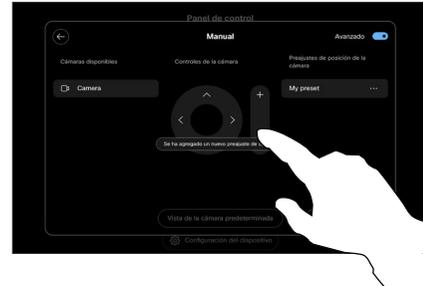
Seleccione **Manual** en la pantalla de control de la cámara. Utilice los controles de la cámara para ajustar la vista, la inclinación y el enfoque.
