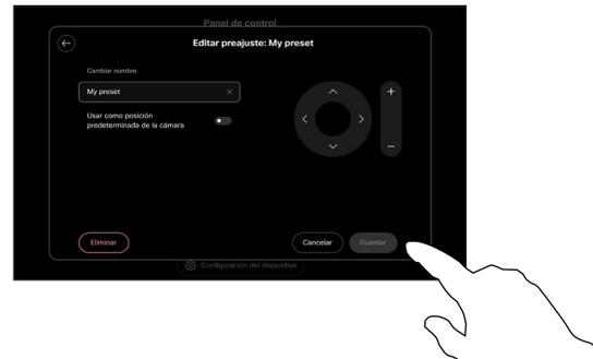
**Guarde** los cambios. Puntee la flecha hacia atrás para salir de los controles manuales de la cámara. El preajuste editado aparecerá para la selección junto con los demás modos de la cámara.
