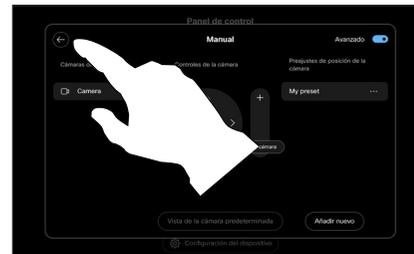
Puntee la flecha hacia atrás para salir de los controles manuales de la cámara. El ajuste preestablecido aparecerá para la selección junto con los demás modos de la cámara.
