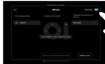
Active **Avanzado** en la esquina superior derecha de la pantalla de controles. Si el dispositivo usa más de una cámara, seleccione una cámara a la izquierda. Utilice los controles para ajustar la panorámica, la inclinación y el zoom.
