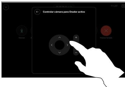
Ajuste la inclinación, la panorámica y el zoom de la cámara remota mediante los botones de control de la cámara. Puntee cualquier lugar fuera de los controles cuando haya terminado.
