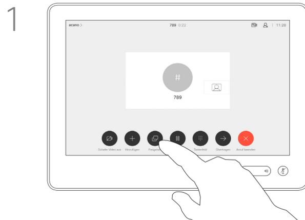
Verbinden Sie die Quelle mit einem geeigneten Kabel mit dem Videosystem, stellen Sie sicher, dass es eingeschaltet wurde, und tippen Sie auf **Freigeben**.
