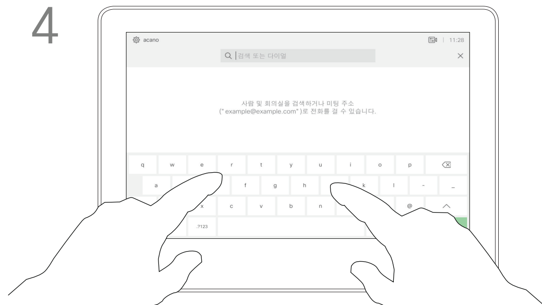
4 이름, 번호 또는 IP 주소를 입력합니다. 입력함에 따라 일치 항목이 나타납니다. IP 주소에 사용된 마침표 기호를 입력하려면 *을 길게 누릅니다.
