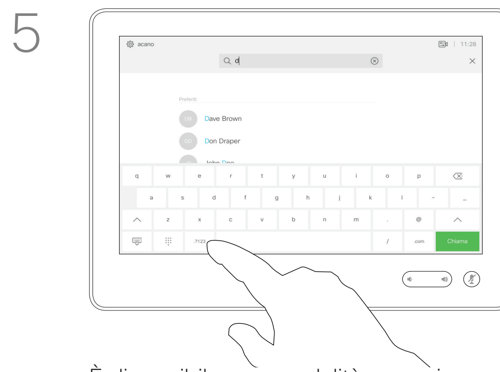
È disponibile una modalità numerica estesa che contiene i caratteri speciali. Per passare dalla modalità alfanumerica a quella numerica e a quella estesa, toccare il tasto nell'angolo in basso a sinistra della tastiera, come indicato.
