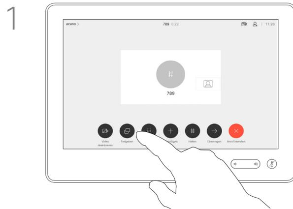
1 Verbinden Sie die Quelle mit einem geeigneten Kabel mit dem Gerät, stellen Sie sicher, dass es eingeschaltet wurde, und tippen Sie auf **Freigeben**.
