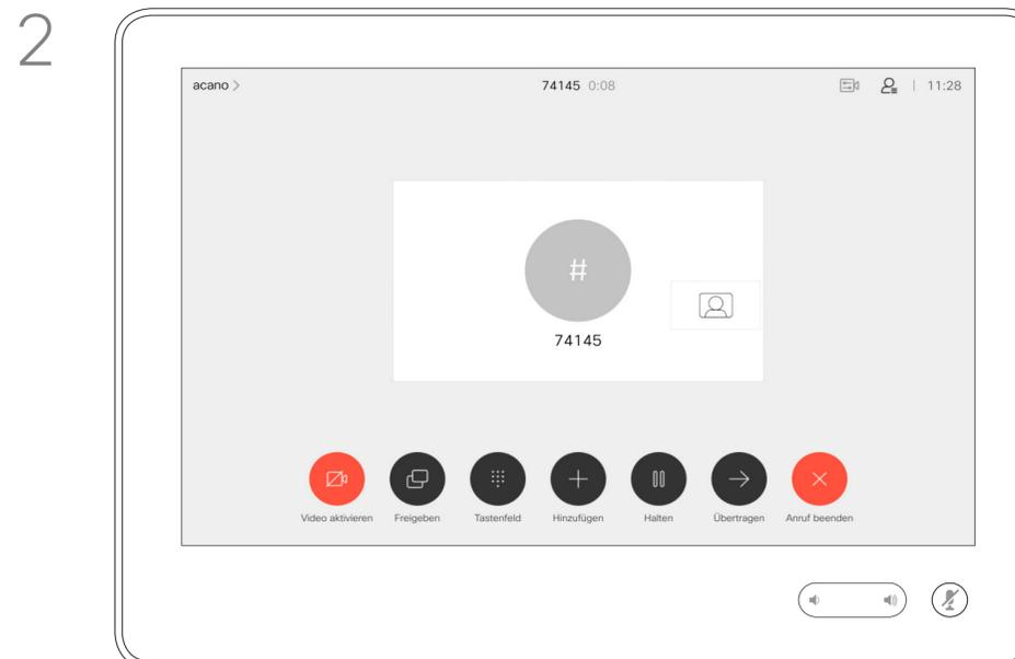
Das Symbol leuchtet rot, um anzuzeigen, dass kein Video vom Gerät gesendet wird. Tippen Sie erneut, um die Funktion zu deaktivieren.
