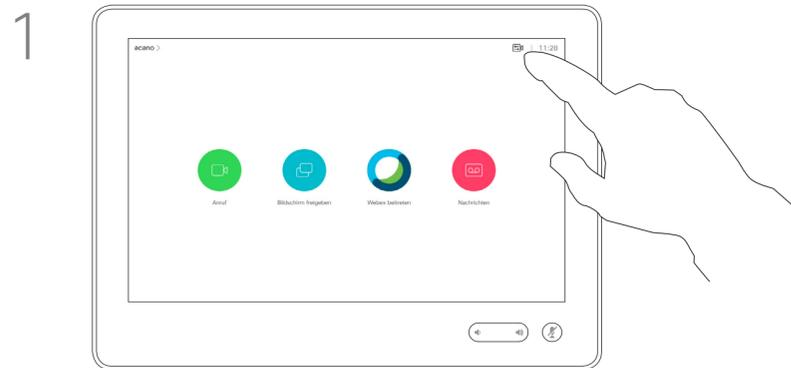
Tippen Sie auf **Kamera**, um das Menü für die Kameraanpassung zu öffnen.
