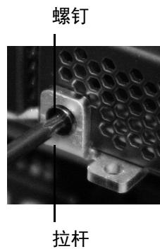
2. 将拉杆拉离模块以打开锁扣。锁扣的近端可见。锁扣的远端在模块内部。
