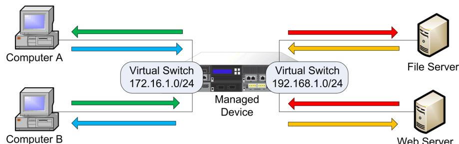
在本示例中，受管设备监控来自两个独立网络（172.16.1.0/20 和 192.168.1.0/24）的流量。虽然这两个网络由同一受管设备监控，但是虚拟交换机仅向同一网络上的计算机或服务器传输流量。流量可以通过 172.16.1.0/24 虚拟交换机从计算机 A 传输到计算机 B（用蓝色线表示），也可以通过同一虚拟交换机从计算机 B 传输到计算机 A（用绿色线表示）。同样，流量可以通过 192.168.1.0/24 虚拟交换机在文件和网络服务器之间往返传输（用红色线和橙色线表示）。但是，流量不能在计算机与网络服务器或文件服务器之间传输，因为计算机与这些服务器不在同一个虚拟交换机上。
