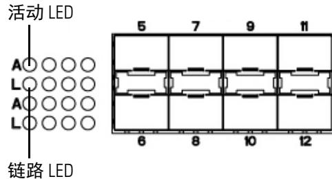
位于插槽左侧的 LED 显示有关每个接口的活动和链路信息。有关详细信息，请参阅第 146 页的[3D7115、3D7125 和 AMP7150 SFP 插槽活动/链路 LED](#)。
