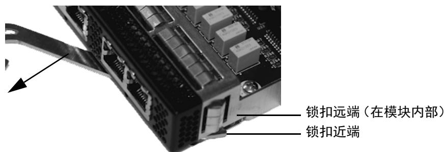
3. 将模块插入插槽，直至锁扣的远端在插槽内，锁扣的近端触及模块插槽的外侧。
