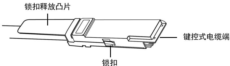
按每种设备配置的要求使用 8000 系列堆栈电缆在主设备与每台辅助设备之间创建物理连接：
