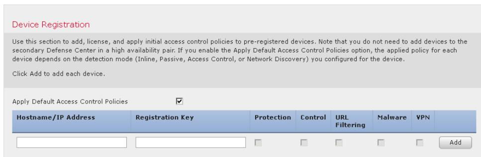
在注册设备时，如果要在注册后自动对设备应用访问控制策略，请保持启用 **Apply Default Access Control Policies** 复选框。请注意，您无法选择防御中心应用于每个设备的策略，仅可选择是否应用策略。应用到每个设备的策略取决于配置设备时选择的检测模式（请参阅第 87 页的[检测模式](#)），如下表所列。
