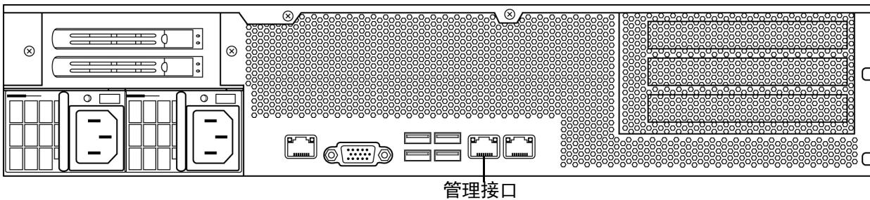
3D8350 作为 2U 设备提供。3D8360、3D8370 和 3D8390 作为 2U 设备提供（带一台、两台或三台辅助 2U 设备）。以下机箱背面示意图显示了每台 2U 设备的管理接口的位置。
