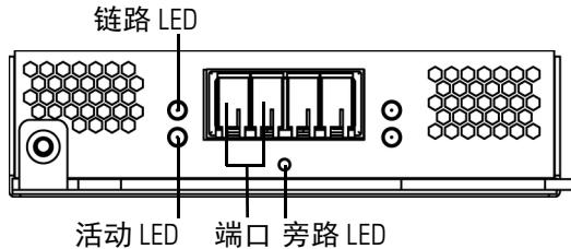
双端口 10GBASE 光纤可配置旁路配置使用 LC 类型（本地连接器）光收发器。请注意，这些接口可以是 MMSR 或 SMLR 接口。
