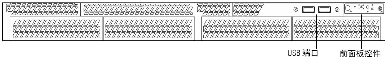
下图显示 DC750（第 1 版）的前面板控件和 LED。
