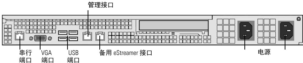
DC3500 系统组件：后视图表介绍显示在设备背面的功能。
