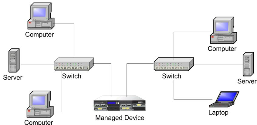
除了使用一台设备监控两个网段之外，还可以使用设备的虚拟交换机功能来代替部署中的两个交换机。
