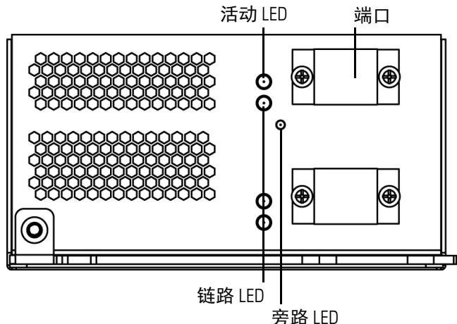
您仅可在 3D8270、3D8290、3D8360、3D8370 和 3D8390 中使用 40G 网络模块；或者在具有 40G 功能的 3D8250、3D8260 和 3D8350 中使用该网络模块。如果您尝试在不支持 40G 的设备上创建 40G 接口，在其管理防御中心网络界面上的 40G 接口屏幕将显示红色。支持 40G 的 3D8250 在 LCD 面板上显示“3D 8250-40G”，支持 40G 的 3D8350 在 LCD 面板上显示“3D 8350-40G”。有关位置信息，请参阅第 61 页的 [8000 系列模块](#)。
