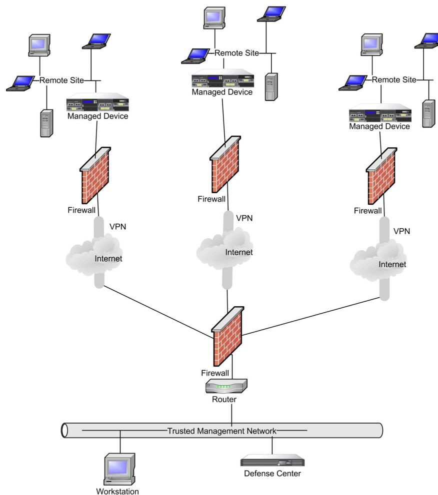
可以用每个网段上部署的受管设备代替防火墙和路由器。
