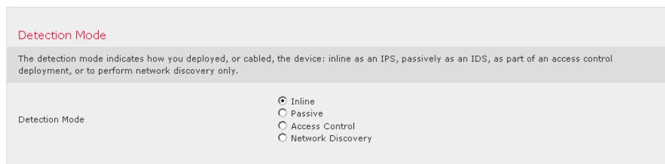
检测模式不是以后可更改的设置；它是您在设置过程中选择的选项，用于帮助系统定制设备的初始配置。一般来说，应根据您的设备部署方式选择检测模式：
