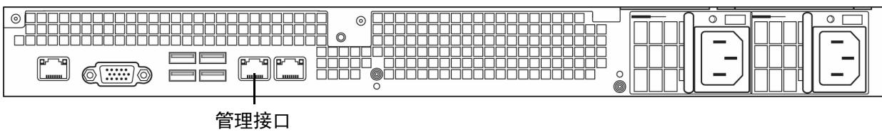
3D8250 作为 2U 设备提供。3D8260、3D8270 和 3D8290 作为 2U 设备提供（带一台、两台或三台辅助 2U 设备）。以下机箱背面示意图显示了每台 2U 设备的管理接口的位置。
