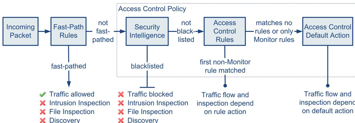
首先按照任何快速路径规则检查传入数据包。如果匹配，该流量将经由快速路径传输。如果没有匹配项，基于安全情报的过滤功能将确定该数据包是否已被列入黑名单。如果不是，将应用任何访问控制规则。如果该数据包符合规则中的条件，流量和检查取决于规则操作。如果没有规则与该数据包匹配，流量和检查取决于默认策略操作。（监控规则属于例外，此类规则允许持续评估流量。）每个访问控制策略的默认操作管理未经由快速路径传输或未列入黑名单的流量，或与任何非监控规则匹配的流量。请注意，快速路径仅适用于 8000 系列和 3D9900 设备。
