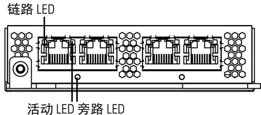
您可以使用这些连接以被动方式监控多达四个独立网段。您还可以使用内联模式的或与旁路模式内联的成对接口将设备部署为最多两个网络上的入侵防御系统。
