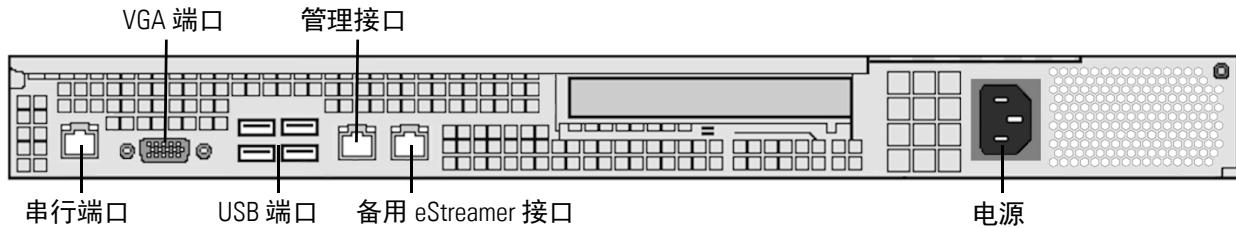
DC1500 系统组件：后视图表介绍显示在设备背面的功能。
