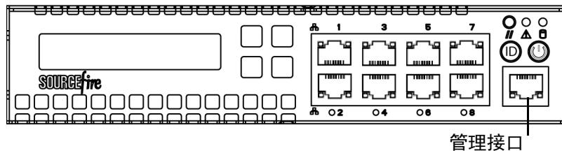
3D7110/7120、3D7115/7125 和 AMP7150 作为 1U 设备提供。以下机箱背面示意图显示了管理接口的位置。
