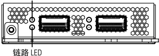
堆栈模块可供您组合两台设备的资源，使用一个作为主设备，另一个作为辅助设备。只有主设备具有感应接口。以下设备可使用堆栈模块：
