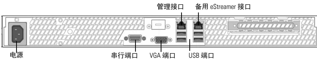
[DC750 系统组件：后视图表介绍](#)显示在设备背面的功能。
