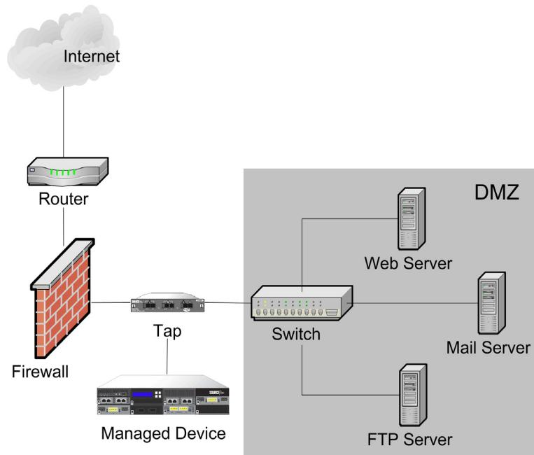
在此方案中，分路器通过单独的端口传输传入流量和传出流量。在受管设备上将多端口适配器卡连接至分路器后，受管设备就能将流量整合到一个统一的数据流中，从而可以对其进行分析。
