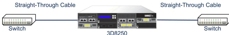
**硬件旁路的有效配置**表列出了硬件旁路配置中哪些情况下应使用交叉电缆，哪些情况下应使用直通电缆。请注意，第 2 层端口在部署中用作直通 (MDI) 终端，第 3 层端口在部署中用作交叉(MDIX) 终端。总交叉数（电缆和设备）应为奇数，旁路才能正常工作。
