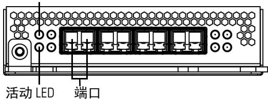
四端口 10GBASE 光纤非旁路配置使用带 MMSR 或 SMLR 接口的 LC 类型（本地连接器）光收发器。
