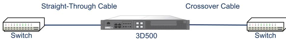
对于使用交叉连接旁路的受管设备，请像未部署设备一样正常连接设备。这种连接在设备断电的情况下应该仍能够正常工作。大多数情况下，应使用两根直通电缆将设备连接至两个终端。
