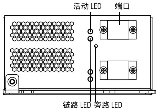
双端口 40GBASE-SR4 光纤可配置旁路配置使用 MPO（多光纤插拔式）连接器光收发器。
