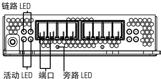
四端口 1000BASE-SX 光纤可配置旁路配置使用 LC 类型（本地连接器）光收发器。
