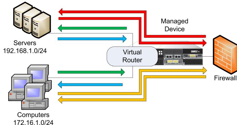
在本示例中，受管设备包含一个虚拟路由器，该路由器实现网络 172.16.1.0/20 上的计算机与网络 192.168.1.0/24 上的服务器之间的流量传输（用蓝色线和绿色线表示）。虚拟路由器上的第三个接口允许来自每个网络的流量在防火墙之间往返传输（分别用红色线和橙色线表示）。
