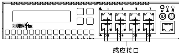
您可使用这些连接以被动方式监控多达八个独立网段。您还可使用处于内联模式或支持旁路功能的内联模式的成对接口，将设备在多达四个网络上部署为入侵防御系统。
