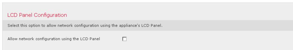
**警告！** 启用此选项可能会引入安全风险。要使用 LCD 面板配置网络设置，您只需亲身接近，而无需进行身份验证。有关详细信息，请参阅第 98 页的[使用 3 系列设备上的 LCD 面板](#)。
