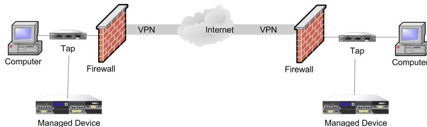
可以用受管设备代替 VPN 连接任一端的分路器。请注意，如果用受管设备代替分路器，将会失去分路器数据包传输保障。
