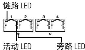
您可使用这些铜缆接口以被动方式监控最多四个独立网段。您还可使用处于内联模式或支持旁路功能的内联模式的成对接口，将设备在最多两个网络上部署为入侵防御系统。
