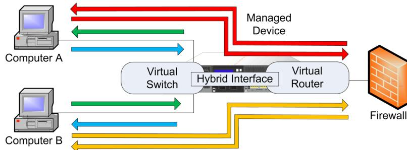
在本示例中，计算机 A 和计算机 B 位于同一个网络中，并且使用受管设备上配置的第 2 层虚拟交换机进行通信（用蓝色线和绿色线表示）。受管设备上配置的虚拟路由器提供对防火墙的第 3 层访问。混合接口整合了虚拟交换机和虚拟路由器的第 2 层和第 3 层功能，允许流量从每台计算机通过混合接口传输至防火墙（用红色线和橙色线表示）。
