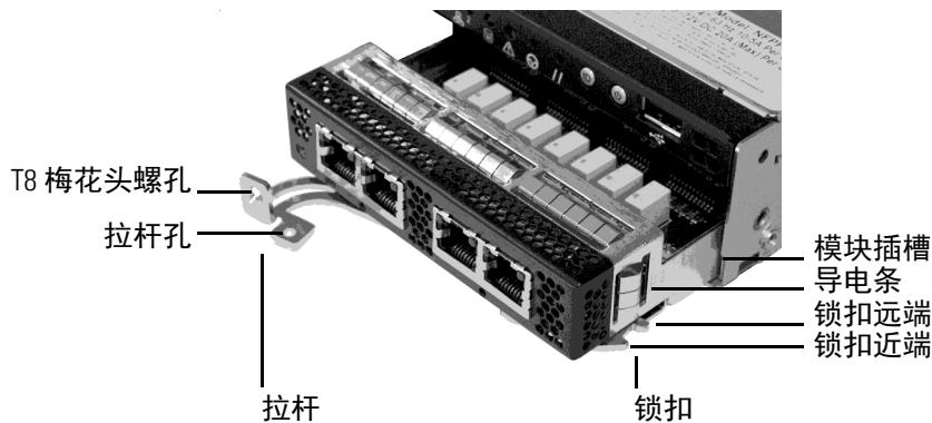
示例模块拉杆（合上，孔内已安装螺钉）
