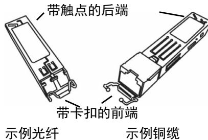
3D7115、3D7125 和 AMP7150 可支持最多八个 SFP 收发器（以下三种规格的任意组合）：
