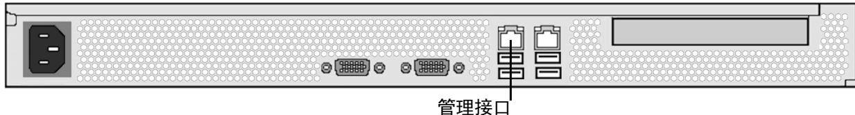
以下机箱背面示意图显示了 DC750（第 2 版）上的管理接口的位置。
