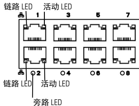
如果希望充分利用设备的自动旁路功能，您必须将两个接口（接口 1 和 2、3 和 4、5 和 6、或 7 和 8）纵向连接至网段。即使设备发生故障或断电，自动旁路功能也允许流量通过。在使用电缆连接接口后，您可通过网络界面将一对接口配置为内联集，并在该内联集上启用旁路模式。
