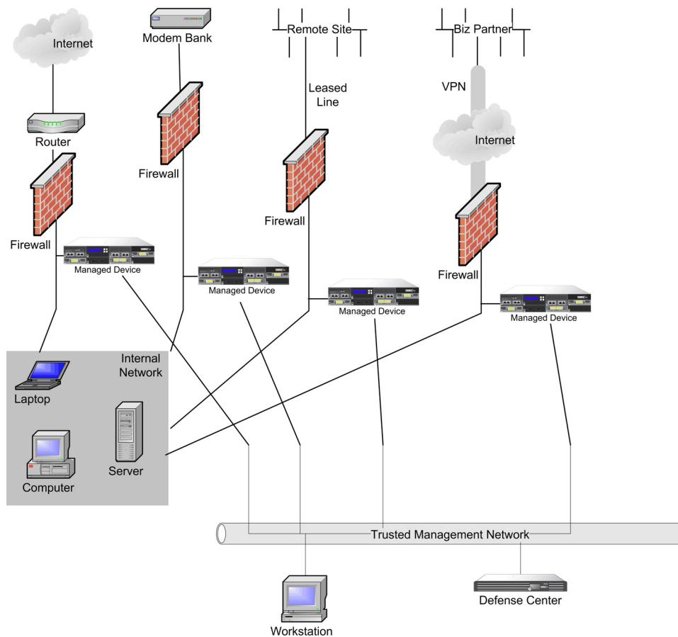
可以用网段上部署的受管设备代替防火墙和路由器。
