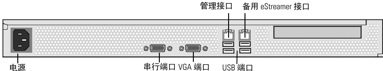
机箱背面包含 DC750（第 2 版）的电源和连接端口。
