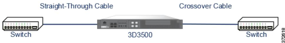
对于使用交叉连接旁路的受管设备，请像在未部署设备的情况下一样正常连接设备。此链路应该在移除设备电源的情况下工作。大多数情况下应使用两根直通电缆将设备连接到两个终端。
