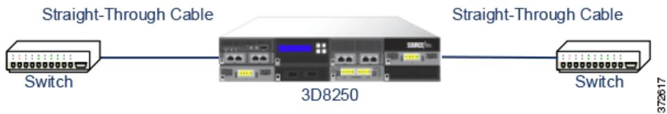
下表列出了硬件旁路配置中哪些情况下应该使用交叉或直通电缆。请注意，第 2 层端口在部署中用作直通 (MDI) 终端，第 3 层端口在部署中用作交叉 (MDIX) 终端。总交叉（电缆和设备）数量应该为奇数，旁路才能正常工作。
