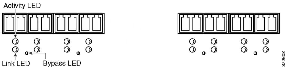
支持可配置旁路功能的八端口 1000BASE-SX 光纤配置使用 LC 型（本地连接器）光纤收发器。
