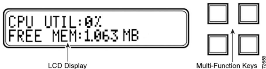
在空闲显示模式下，面板交替显示 CPU 利用率和空闲可用内存以及机箱序列号。按任意键即可中断空闲显示模式并进入可以访问网络配置、系统状态和信息模式的 LCD 面板主菜单。
