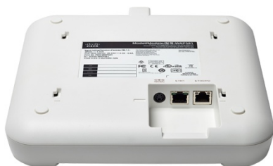
Figura 3. Pannello posteriore dell'access point Wave 2 Wireless-AC Cisco WAP581 a doppia radio con LAN 2,5 GbE
